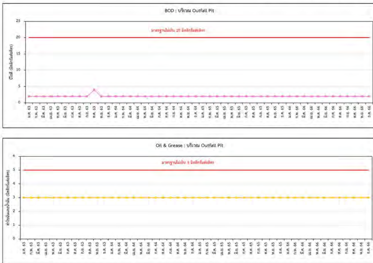
รูปที่ 3.4-27 (ต่อ) เปรียบเทียบผลการตรวจวิเคราะห์คุณภาพน้ำทิ้ง บริเวณ Outfall Pit โครงการโรงงานผลิตโพลิเอททีลีน บริษัท สยามโพลิเอททีลีน จำกัด ระหว่างปี พ.ศ. 2563-2566
